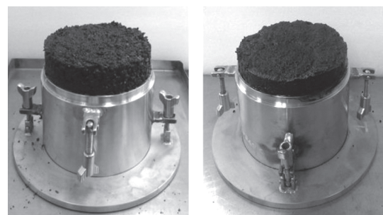
Abbildung 1.5.7 Fotografien gültiger Prüfungen einer teilweise gesättigten Teilprobe (links) und einer nahezu vollständig gesättigten Teilprobe (rechts)
